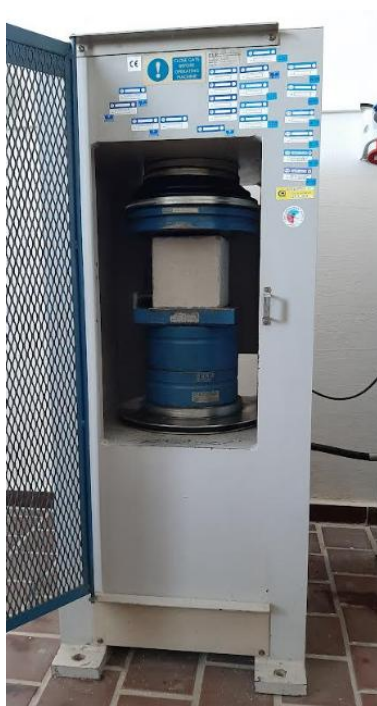
Zkoušky ve stavebních laboratořích – výroba betonu, destruktivní zkouška betonu
